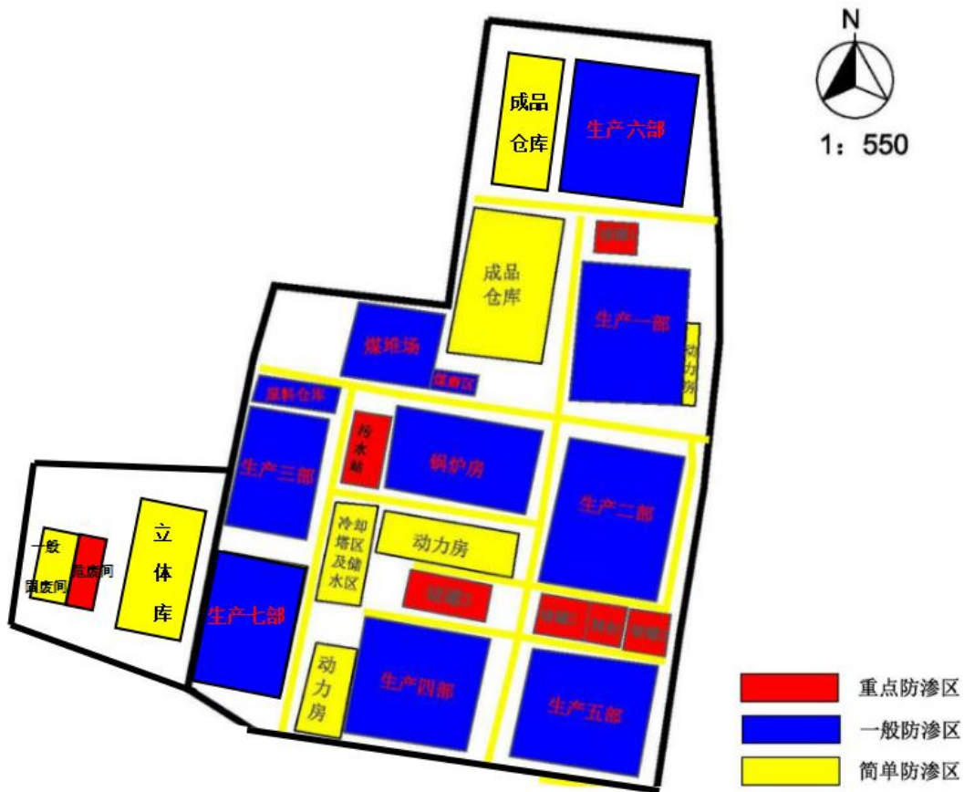
图 7.3-1 厂区地下水分区防渗示意图
